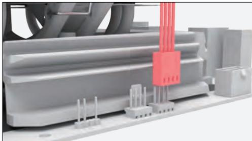
Подключите 4-контактный кабель питания вентилятора к разъему "CPU\_FAN".
