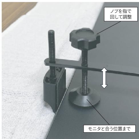
⑦上部金具のノブを回して、背面からの押さえ位置を調整します。仮締めなので、軽く固定される程度に調節してください。
