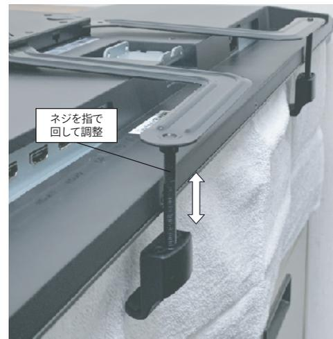
⑤下部のモニター受部品のネジを指で回して、モニターと合う位置まで調節します。仮締めなので、軽く固定される程度に調節してください。
