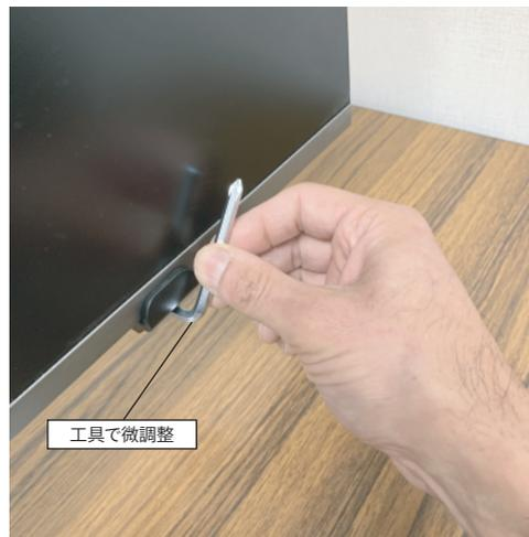
⑫ 下部のモニター受部品のネジを付属工具で微調整します。締めすぎると下部金具が変形するのでご注意ください。
