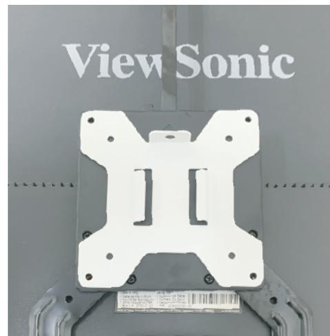
⑨モニターアームと固定します。アーム側取り付け板が取り外せるタイプを例とします。
