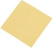
■メモリやビデオチップ等とヒートシンクの間に挟んで使用します ■熱伝導率0.65W/m・K ■38×38×0.125mm ※PA-069型番変更品
