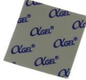
■優れた柔軟性と粘着性で細かい凹凸面に密着します ■熱伝導率: 6.5W/m・K ■35×35×0.5mm ※HT-10型番変更品
