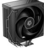
■6mm径ヒートパイプ×4 ■152mm高で狭小ケースにも対応 ■サイドフロー ■120mm静音ファン ■PWM 4ピン ■※SE-224-XTS後継品
