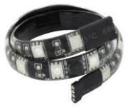
■磁石で簡単設置 ■連結可能 ■RGB LED メス⇄RGB LED メス ■4ピン ■約30cm ■マルチカラー ■※RLD-LED30M型番変更品
