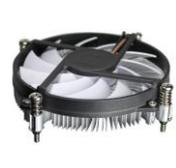
■LGA115x用 ■ネジ&バックプレート固定 ■アルミ+銅コア ■32mm高 ■92mm PWM 4ピンファン
