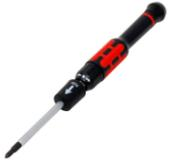
■無段階ラチェット機構搭載の精密ドライバー ■両頭ビット:プラス(PH0)、マイナス(3.0) ■ドライバー長さ約170mm
