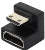
■HDMIミニコネクタの向きを180度反転させHDMIコネクタに変換するアダプタ ■通電LED搭載 ■下向きタイプ ■ブラック
