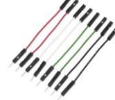
■LED/USB 2.0/1394ケーブルなどとM/Bのピン配列が異なる時に ■抜け防止コネクタ採用 ■2.54mmピッチ ■4.5cm ■8本入 ※EX-002型番変更品
