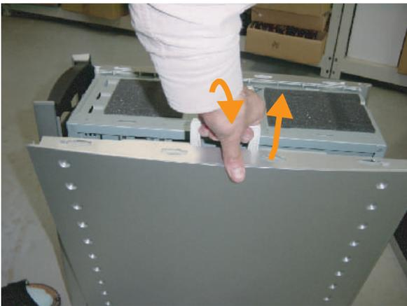
**3** トップカバーを外すとサイドパネルのハンドルが現れます。ハンドルをつかみ上に持ち上げます。上に持ち上げたら、少し外側に開くのでそのまま斜め上に引き抜きます。
