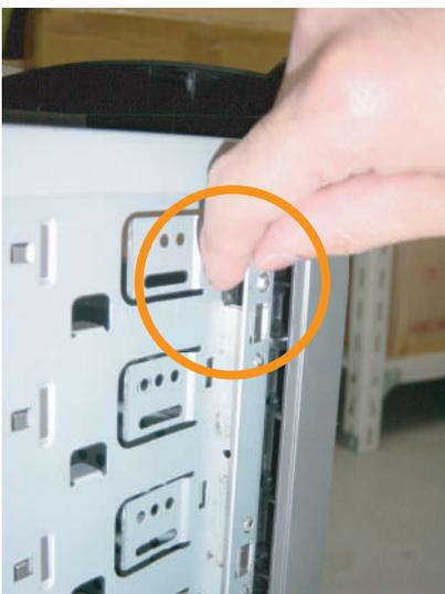
**5** フロントパネルの外し方です。パネルの内側の左右それぞれ3ヶ所・計6ヶ所にツメがあります。片側のツメを全て外します。
