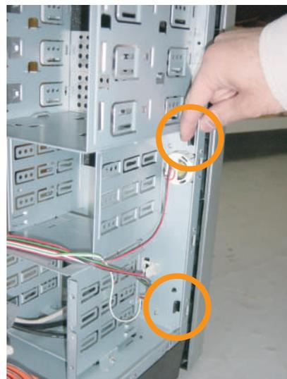
**6** 下まで全部を外してください。片側が全部外れば、あとはフロントパネルを斜めにずらせば外れます。
