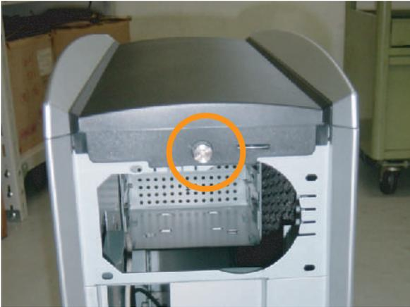
**1** 背面上部の手回しネジを外します。
