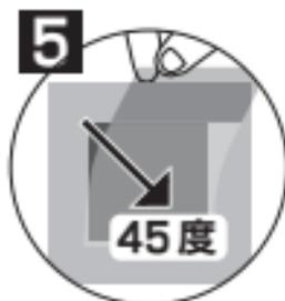
5 ShinEtsuロゴの印刷されたタブフィルムを斜め45度方向に一気に剥します。
