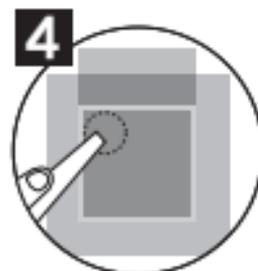
4 プラスチック製へら(GH-01)などで、左上部分を十分に擦り付けます。
