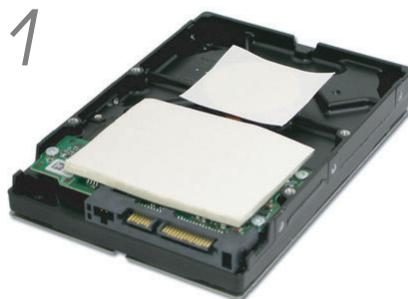
熱伝導パッド①②をHDD底部の基板と駆動部分に貼ります。フィルムを剥がして発熱部分にしっかり押し付けます。最後に台紙を剥がします。
