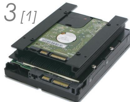
【オプション1】2.5インチHDD/SSDをヒートシンク横から凹部に挿入します。付属ミリネジ④でドライブを固定します。
