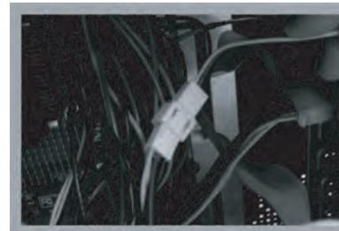
4. ファン本体とパルス分岐ファン用電源ケーブルを接続します。もう一方の分岐されたパルス検出用ケーブルをマザーボードに接続します。
