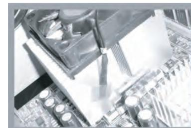
5. 温度センサーケーブルの検知センサー部分を固定用耐熱テープで適切な位置に固定します。
