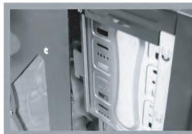
1. PC ケースのサイドパネルと空きの 5 インチベイ前面カバーを取り外します。
