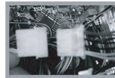
6. 電源ユニット大 4 ピンと電源ケーブルを接続します。
