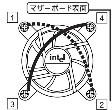
**⚠** ネジの締め過ぎにご注意ください。バックプレートが変形したり、ネジ穴が広がってしまうことがあります。ネジは対角線を一度に締めるのではなく、数回に分けて4か所を均一に締めてください。
