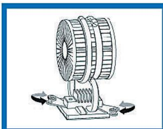
6. 位置調節ができるように、固定金具が左右に動くか確認します。
