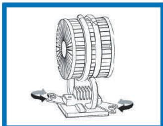
5. 位置調節ができるように、固定金具が左右に動くか確認します。
